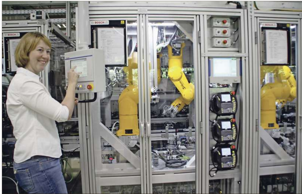
Sechs Roboter auf engstem Raum: Lena Wagner, Bosch-Beauftragte für Industrie 4.0, zeigt die vernetzte Fertigung in der Produktion von Wischeranlagen. Foto: Eiermann
